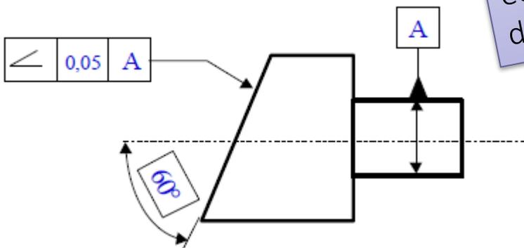
Des tolérances d'orientation permettent de limiter les défauts entre les surfaces de contact : la surface réelle doit être comprise entre deux surfaces idéales écartées de la valeur de la tolérance
