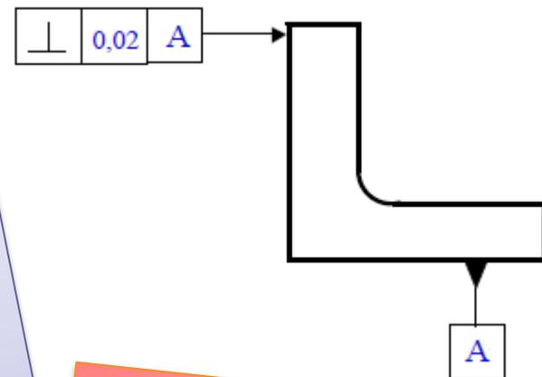
L'hyperstaticité au niveau des associations de contact peut être assurée techniquement par le contrôle géométrique (pb de coût de fabrication) ou l'intégration de réglages (pb de coût de main d'œuvre). Cette hyperstaticité peut être nécessaire afin d'obtenir une rigidité compatible avec le cahier des charges
