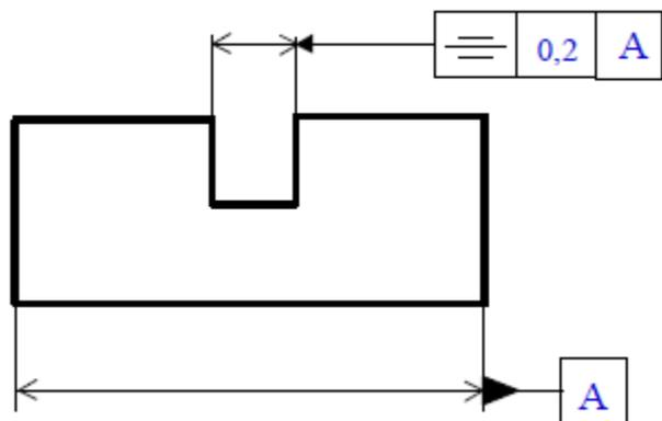
Des *tolérances de position* permettent de limiter les défauts de positionnement entre les surfaces de contact : la surface réelle doit être comprise entre deux surfaces idéales écartées de la valeur de la tolérance
