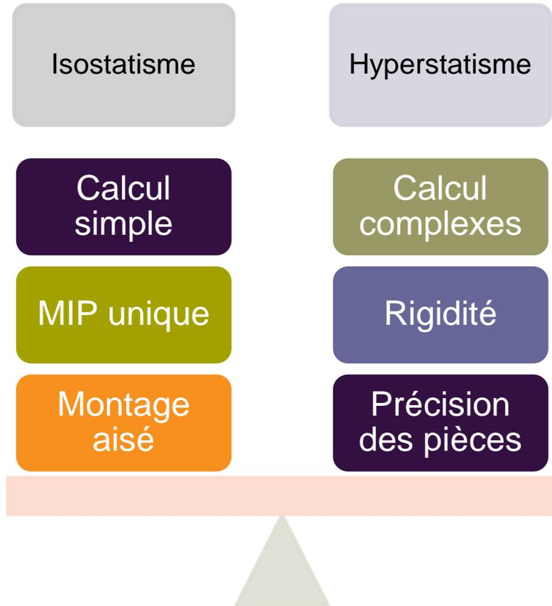
Bien conçue, une liaisons hyperstatique est plus rigide. C'est pourquoi des liaisons « filtres » placées aux entrées et sorties des mécanismes, mais aussi les guidages précis à l'intérieur des mécanismes sont souvent réalisées de cette manière.
