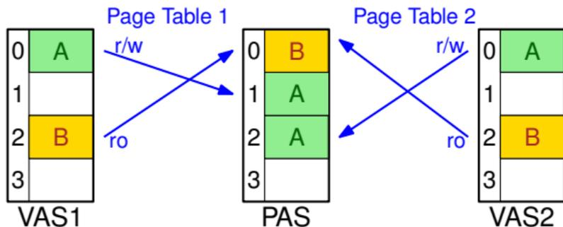
Le noyau constate dans PCB1 que la page est en copy-on-write
