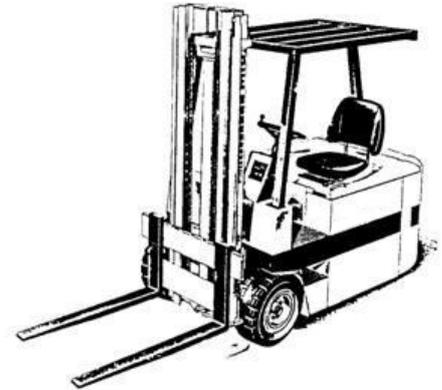
La propulsion est obtenue à partir d'un moteur électrique alimenté par des batteries d'accumulateurs. La puissance du moteur est transmise à la roue motrice par l'intermédiaire :
