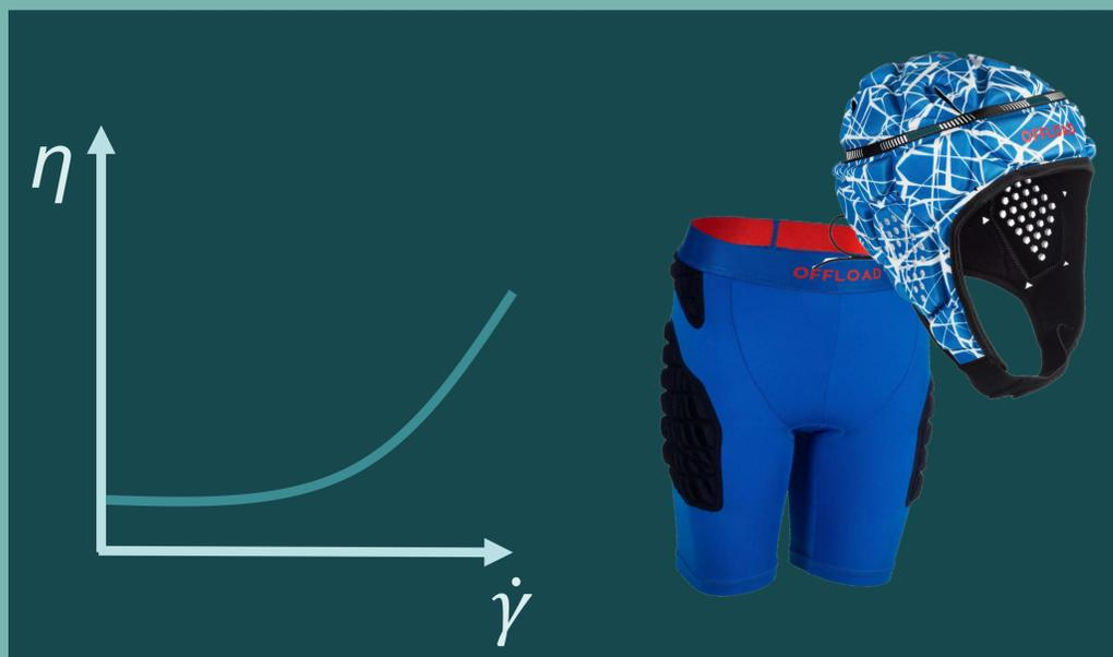
L'idée est d'utiliser les propriétés thixotropiques de la salive de crapaud à contrepieds. Un matériau rhéoépaississant sera utilisé pour des protections légères. Fluide au repos, le matériau sera alors malléable et permettra au joueur d'effectuer tous les mouvements qu'il souhaite. Lors d'un choc, le matériau subit des contraintes importantes et en se durcissant, il absorbe l'énergie du choc.
