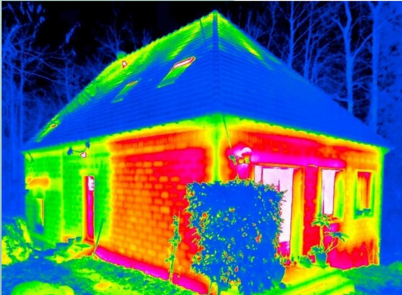
La thermorégulation des bâtiments se fait par des systèmes actifs et passifs. Les systèmes actifs sont relativement énergivores : air conditionné, systèmes de chauffage, de ventilation, etc., tandis que les solutions passives reposent sur l'usage de matériaux isolants à faible conductivité thermique et des revêtements réfléchissants afin de réguler la température par blocage de transfert de chaleur. Ces systèmes sont simples mais non réactifs à des conditions changeantes.
