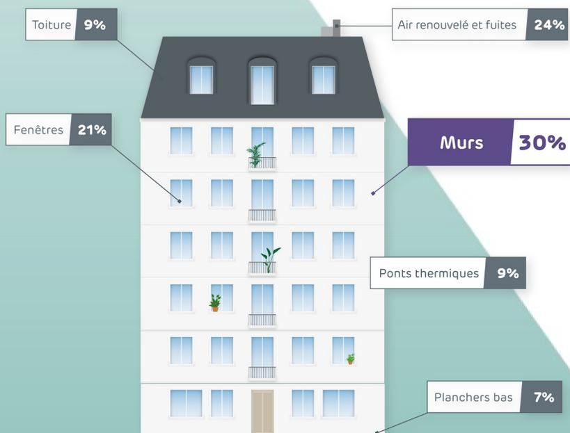
La part du chauffage représente 2/3 des dépenses énergétiques dans les bâtiments, l'isolation des habitations est donc un enjeu majeur d'économies d'énergie. Dans les maisons et les immeubles la part de pertes énergétiques par les murs est une des plus importantes et représente de 25% à 30% des pertes. Il est nécessaire d'isoler les anciens bâtiments mais cela demande de gros travaux très coûteux.
