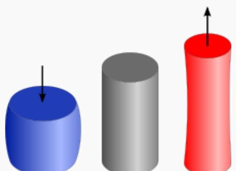
Un module d'élasticité est le rapport entre une contrainte et la déformation relative qui en résulte.
