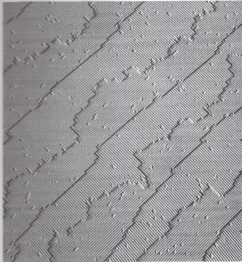
Figure 1.1. Marches [110] sur la face (001) du silicium. Largeur des terrasses : environ 100 Å. Remarquer l'alternance de marches d'allure différente (cf. chap. 9). Technique expérimentale : microscopie tunnel à balayage (STM). (Lagally et al. 1990, avec l'aimable autorisation des auteurs).
