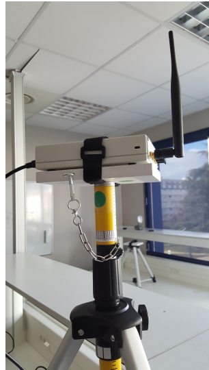
FIGURE 8 – Verrouillage du support de l'USRP à l'aide d'une chaîne.
