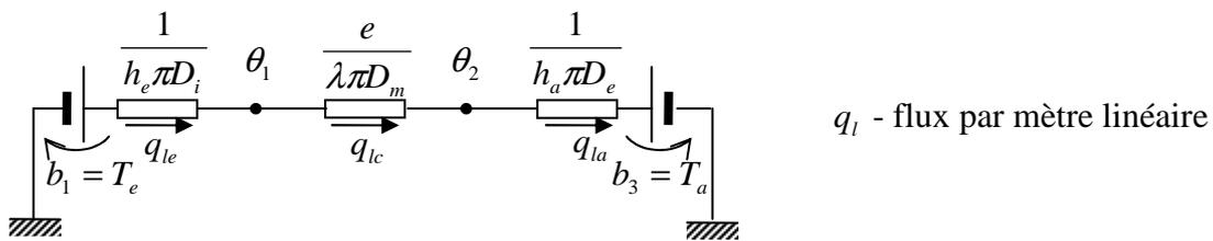
$$\begin{matrix} & \theta_1 & \theta_2 \\ \begin{matrix} q_{le} \\ q_{lc} \\ q_{la} \end{matrix} & \mathbf{A} = \begin{bmatrix} 1 & 0 \\ -1 & 1 \\ 0 & -1 \end{bmatrix} & ; & \mathbf{G} = \begin{bmatrix} h_e \pi D_i & 0 & 0 \\ 0 & \lambda \pi D_m / e & 0 \\ 0 & 0 & h_a \pi D_e \end{bmatrix} & ; & \mathbf{b} = \begin{bmatrix} T_e \\ 0 \\ -T_a \end{bmatrix} \\ & \mathbf{f} = [0 & 0 & 0]^T \end{matrix}$$
