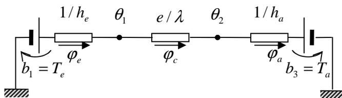
$$\begin{matrix} \varphi_e \\ \varphi_c \\ \varphi_a \end{matrix} \mathbf{A} = \begin{bmatrix} 1 & 0 \\ -1 & 1 \\ 0 & -1 \end{bmatrix}; \mathbf{G} = \begin{bmatrix} h_e & 0 & 0 \\ 0 & \lambda/e & 0 \\ 0 & 0 & h_a \end{bmatrix}; \mathbf{b} = \begin{bmatrix} T_e \\ 0 \\ -T_a \end{bmatrix}$$
