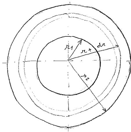
Par raison de symétrie, le gradient de la température est dans la direction du rayon :
