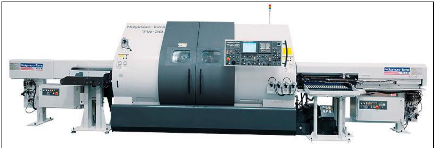
Figure A1.1 : tour bi-broche, bi-tourelle, avec chargeurs de barre : nakamura TW20
