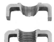
Figure 3 : perçage et taraudage obtenus par fluoperçage
