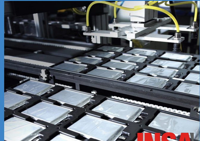
La fabrication d'une batterie NMC de chez Kokam
