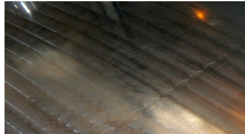
Défaut en balayage 5 axes à la fraise torique en bout
