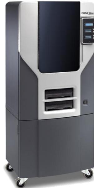
Cette machine du fabricant STRATASYS utilise la technologie FDM, de dépose de couches d'ABS à l'état pâteux (viscosité très élevée). Les avantages de cette machine sont son enceinte régulée thermiquement (ici réglé à 70°C) et sa matière support soluble par immersion dans un bain de soude.
