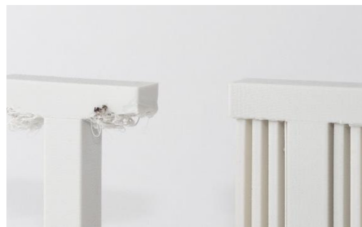
Figure 6 : Défauts liés à une absence de support
