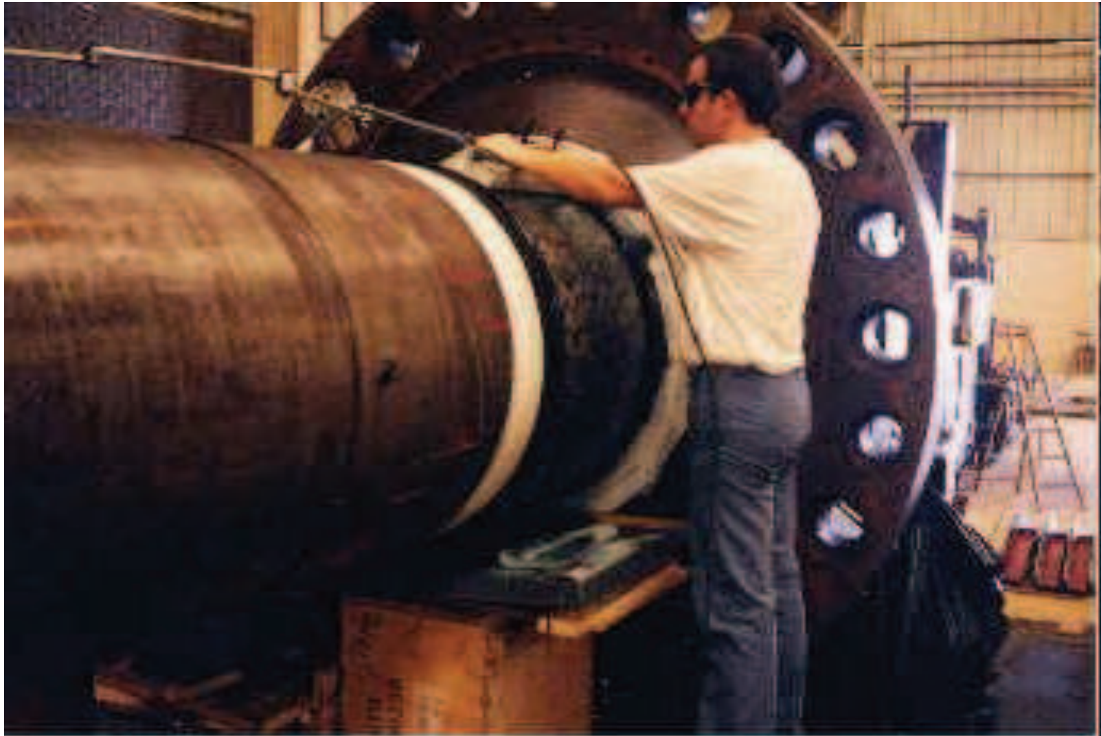
Electrolyse au tampon sur arbre de turbine.
