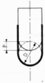
$p$  = distance de pénétration de l'obturateur dans la section, supposée circulaire, offerte par le robinet-vanne au passage du liquide, exprimée en mètres;
