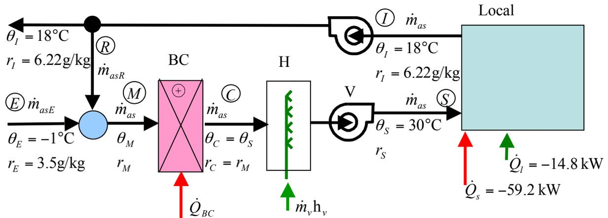
Les équations de bilan pour le local, la boîte de mélange, la batterie de chauffage et l'humidificateur :
