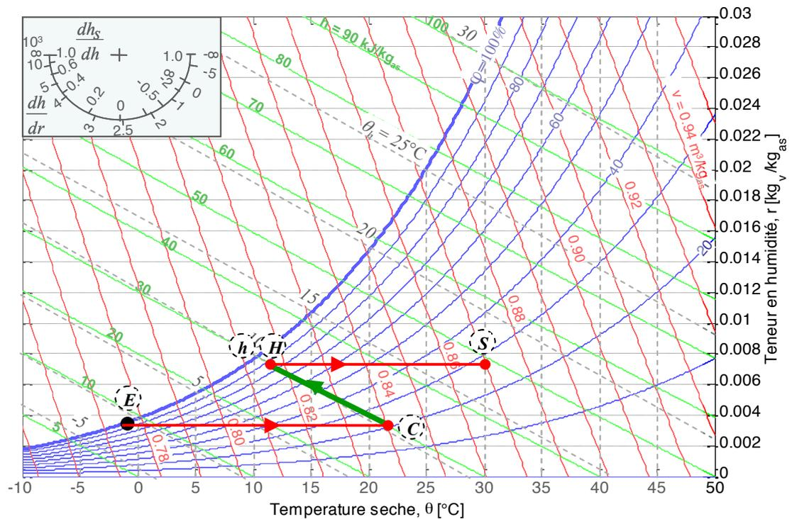
Considérons que l'humidificateur est adiabatique. La transformation de l'air dans cet humidificateur se fait entre  $r_E = r_C = 3.50 \cdot 10^{-3} \text{ kg}_v/\text{kg}$  et  $r_H = r_S = 7.42 \cdot 10^{-3} \text{ kg}_v/\text{kg}$ .
