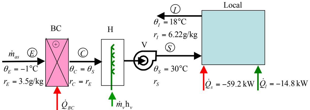
Les équations de bilan pour le local, la batterie de chauffage et l'humidificateur :
