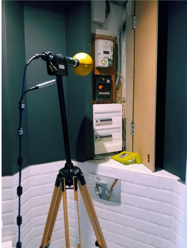
Figure 2 : installation de la sonde de mesure à 50cm de l'ERL (clé Atome de Direct Energie)
