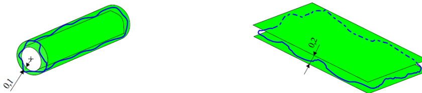
Figure 7 : tolérance de cylindricité et tolérance de planéité. Ci-dessous, rugosité adaptée à la fonction
