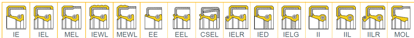
Figure 55 : exemple de variété de joints à lèvres chez un fournisseur (PAULSTRA)
