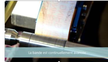
Superfinition par toilage -  $R_a = 0,1\mu\text{m}$
