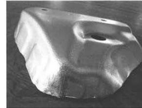
**Vermiculure :** induit par un **vieillessement de la tôle** (petits atomes de carbone ou d'azote en solution dans le réseau cristallin). Elle favorise une localisation de la déformation sous forme de bandes (bandes de Lüders dans un essai de traction). La solution est de faire une phase de skin-pass pour écrouir le matériau.
