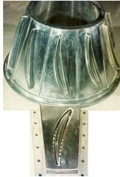
La pièce fait 35cm de diamètre et de hauteur. Le matériau est un superalliage à base Ni, usiné sous 12V et 10000A.
