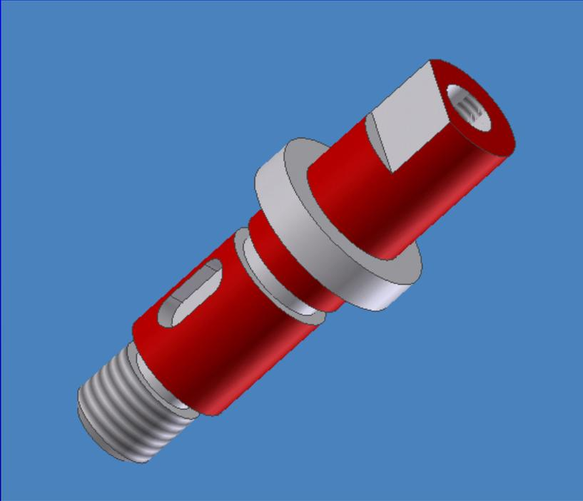
Désigne généralement une pièce cylindrique précise. C'est le contenu dans un assemblage avec un alésage.
