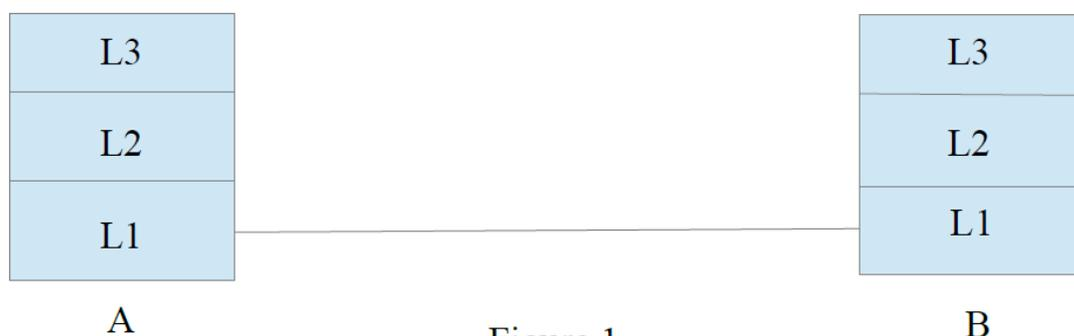
Chaque couche utilise deux primitives pour interagir avec les couches adjacentes : *LX.request(DATA)* et *LX.indication(DATA)*. Donnez les appels de primitives effectués par les différentes couches afin de transférer les données entre les deux machines. On va considérer que L3 utilise des messages d'acquiescement (20 octets), alors que les couches L1 et L2 fonctionnent sans acquiescement.
