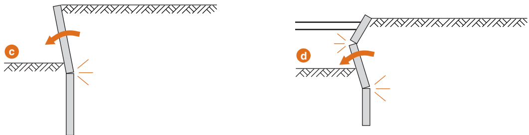
Insuffisance du dimensionnement des palplanches (c, d)
