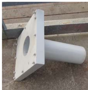
Photo 6.4 : tube trompette (©Alexis Piron-EDF)
