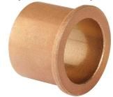
**Note :** le **matériau** du coussinet fait tout son intérêt! Polymère et PTFE ont des coefficients de friction bas. Pour le bronze, obtenu par frottage de poudre, le matériau poreux est préalablement imprégné d'un lubrifiant qui se libère lors de l'usage, d'où l'appellation « autolubrifié »
