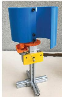
Éléments d'assemblage imprimés en ABS
