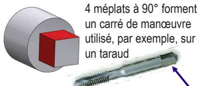
4 méplats à 90° forment un carré de manœuvre utilisé, par exemple, sur un taraud
