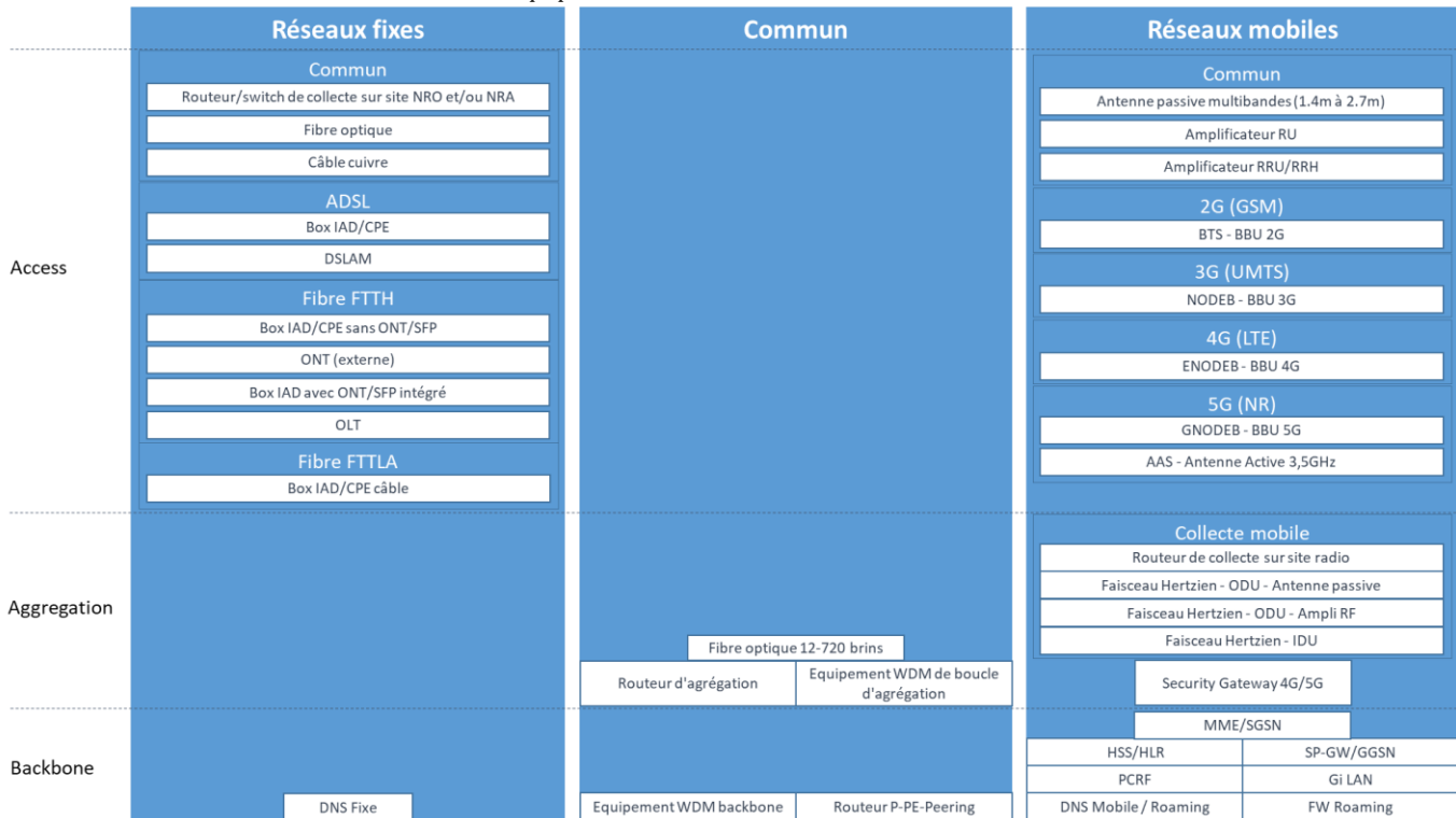
Figure 8 - Equipements constitutifs des réseaux
