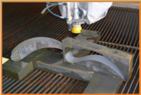
Acier Inoxydable ép. 50 mm
