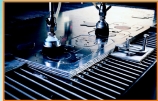
Aluminium ép. 6mm en multi-couche
