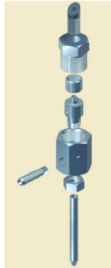
Forme éclatée d'une tête de découpe pour jet d'eau abrasif
