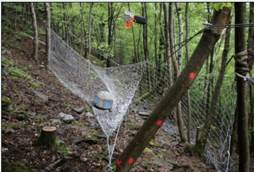
Filet pare-blocs ancré sur les arbres : ouvrage expérimental et modèle numérique. Collaboration INRAE / NGE Fondations
