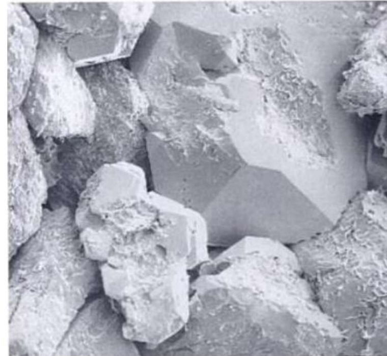
Grès des Vosges. Vue au microscope électronique (photothèque IFP)
