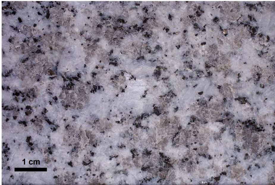
Granite gris du Sidobre (poli). Blancs : feldspaths (microcline 12% et plagioclases 39%) ; gris : quartz 39% ; noir : biotite 10%. Bon exemple de structure holocristalline. Ce granite est en réalité une
