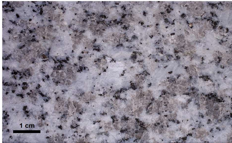
Granite gris du Sidobre (poli). Blancs : feldspaths (microcline 12% et plagioclases 39%) ; gris : quartz 39% ; noir : biotite 10%. Bon exemple de structure holocristalline. Ce granite est en réalité une
