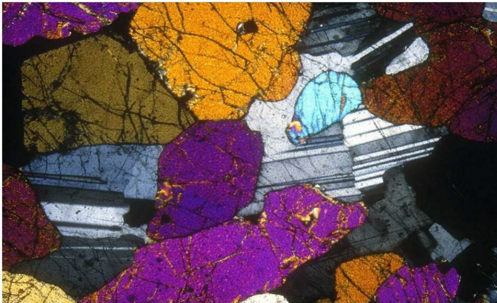
Gabbro : on voit bien les pyroxènes aux teintes vives ( fissurés ) et les plagioclases en pyjama rayé.
