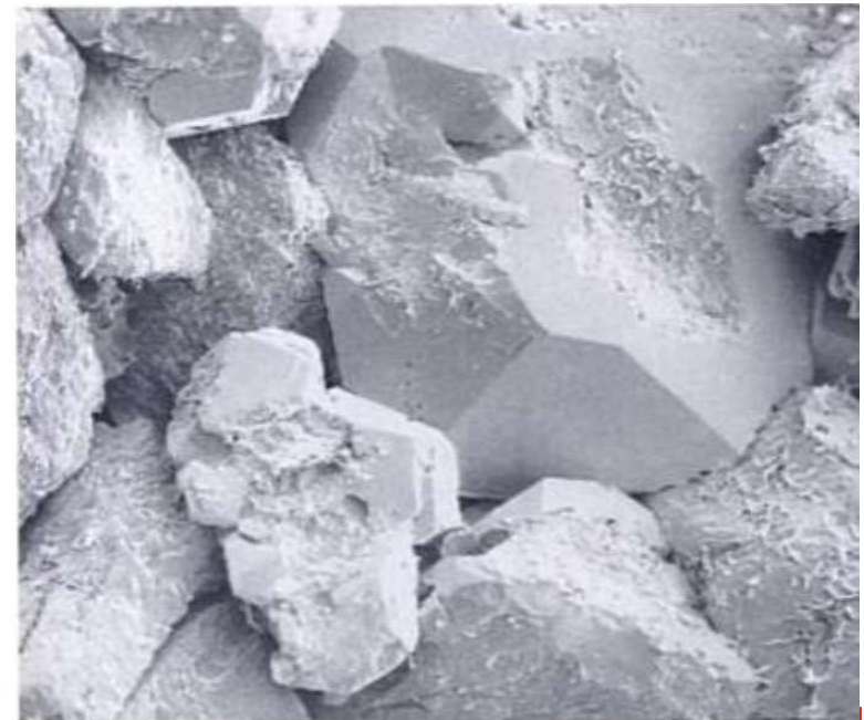
Grès des Vosges. Vue au microscope électronique (photothèque IFP)
