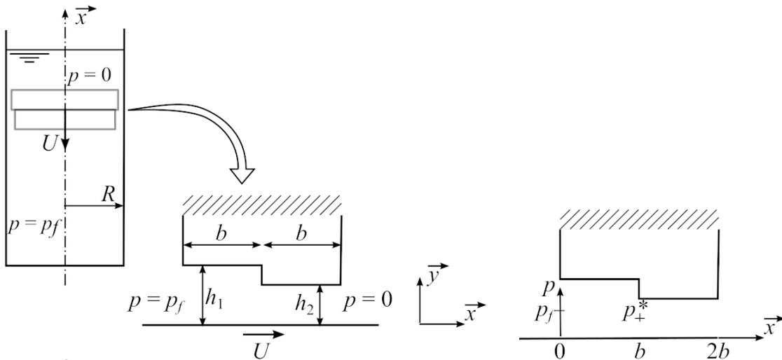
Figure 2. À gauche : principe du viscosimètre étudié / Left: principle of the studied viscometer
